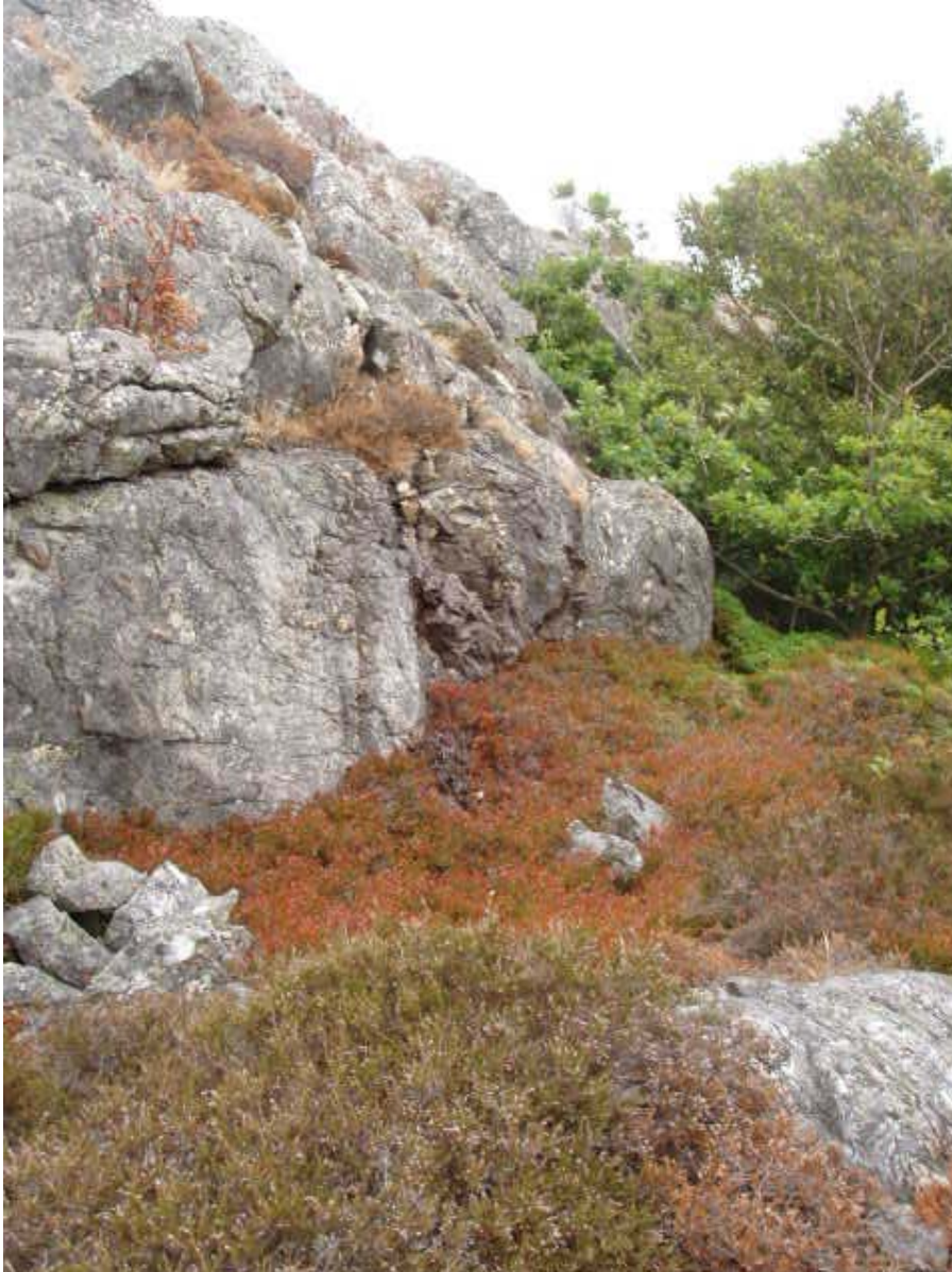
Foto 5: Instabil slänt nedanför vilken hus planeras byggas. Bergssidan är skivigt/blockigt uppsprucken med flera nedfallna block.
